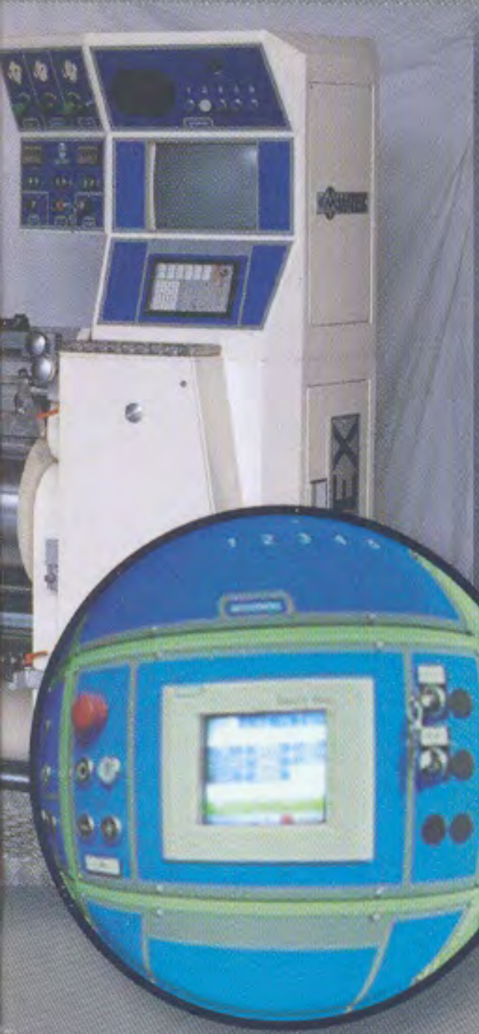
Testa di spalmatura Mod. SP-24 (lama a spessore)
