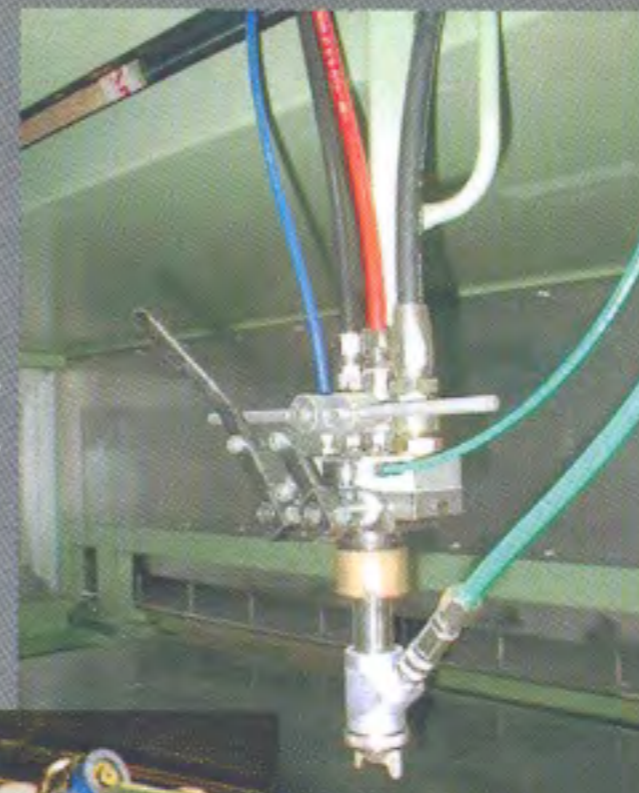
Pistola di spruzzatura per due componenti con miscelatore ed autolavaggio (movimento alternativo)
