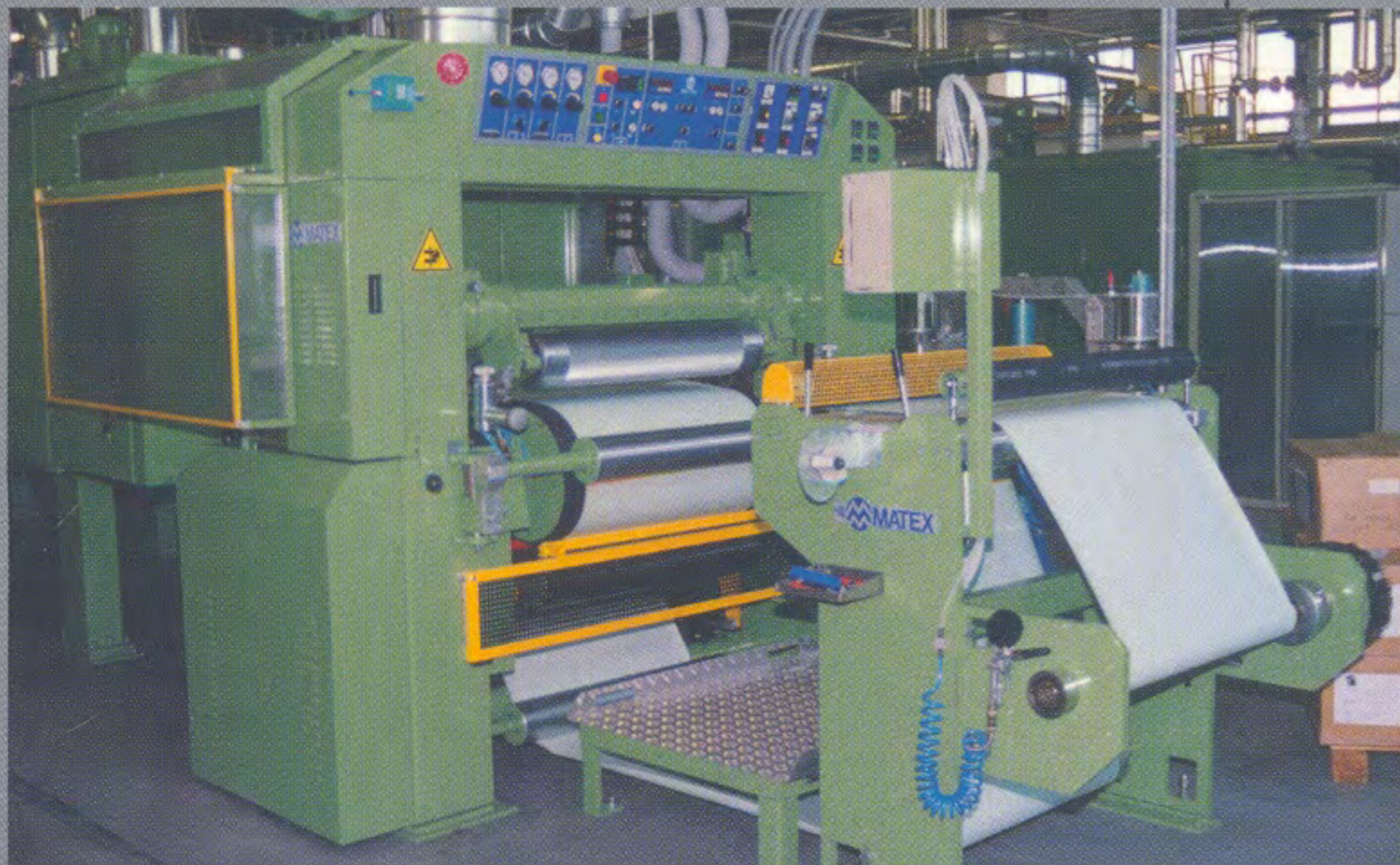
Testa di spalmatura Mod. SP-A (lama a spessore/aria o con cilindro inciso) Coating head Mod. SP-A (doctor blade, air knife, coating cylinder)
