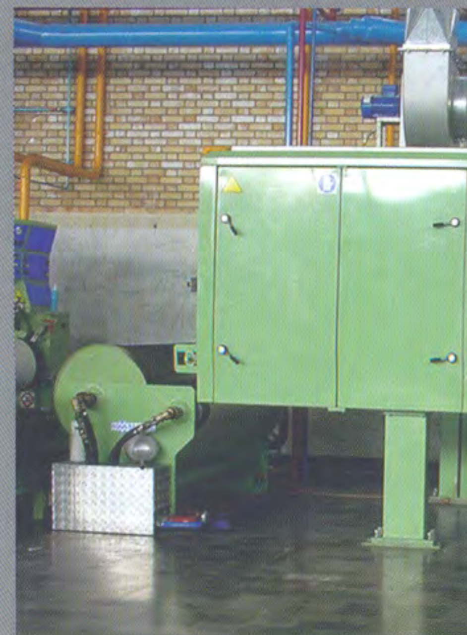
Termocanale di asciugamento a singola ventilazione Mod. TSV
