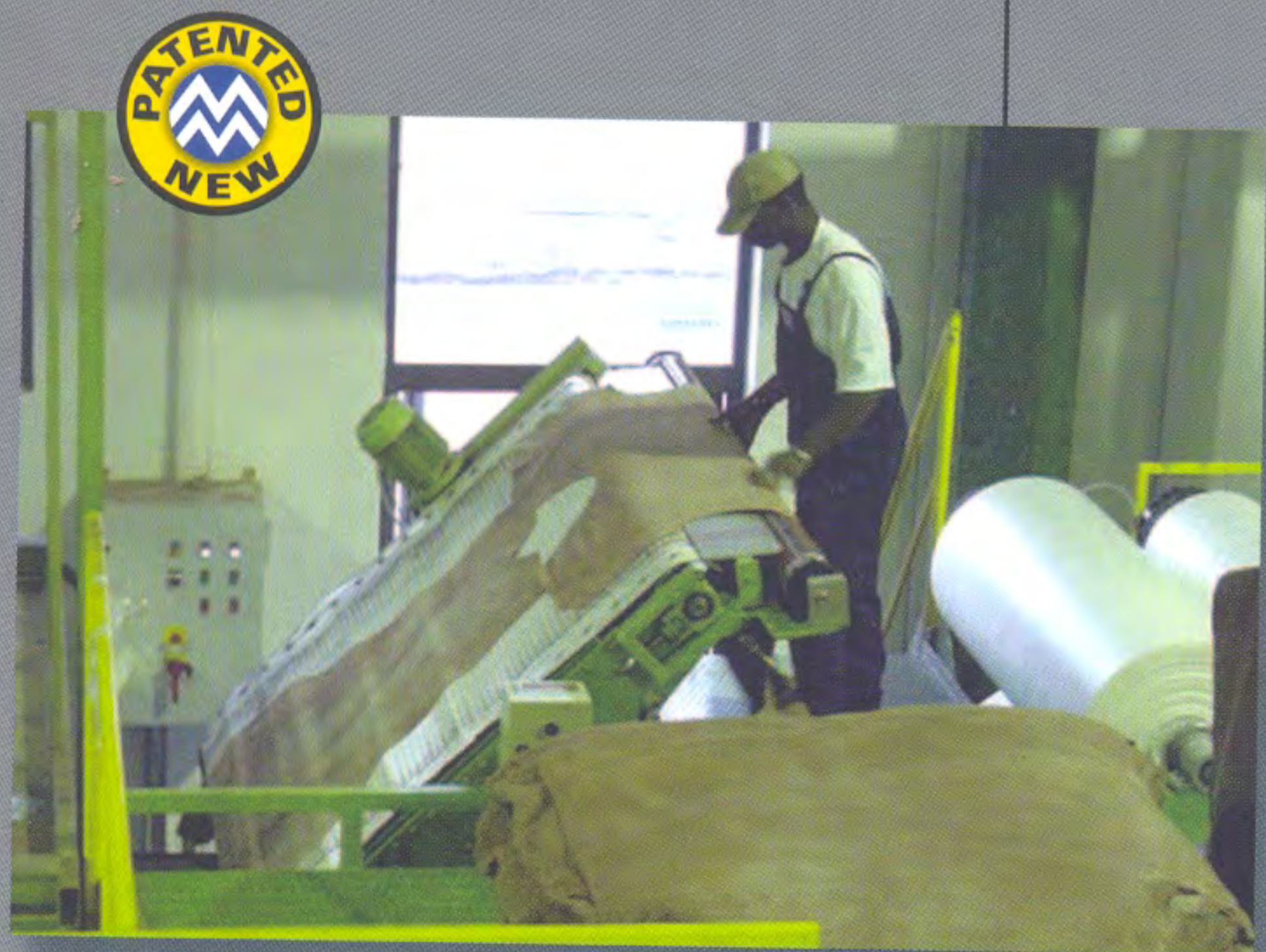
Accoppiamento pelli (a depressione d'aria) Leather laminating unit (negative pressure)
