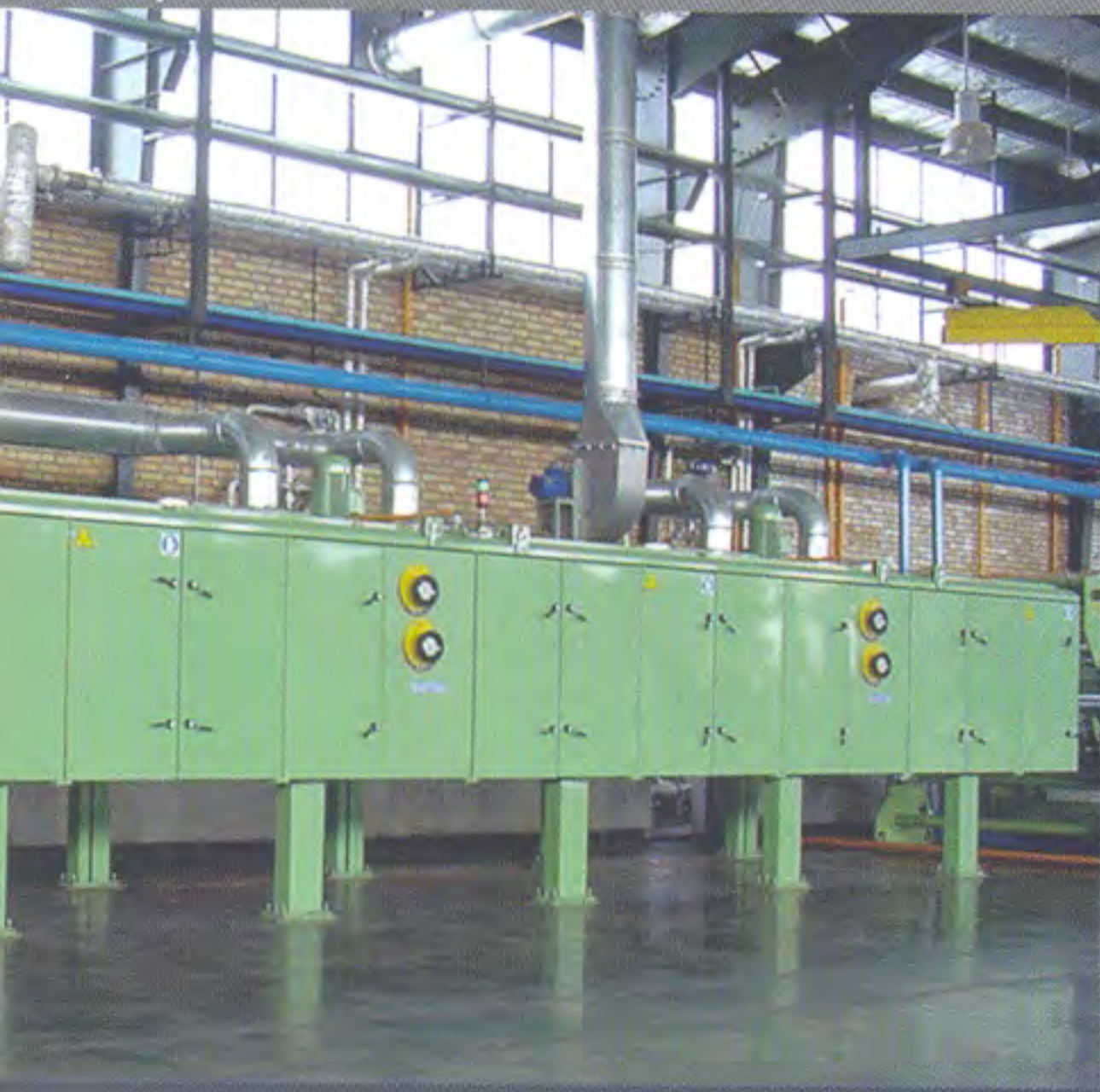
Termocanale di asciugamento a doppia ventilazione Mod. TDV
