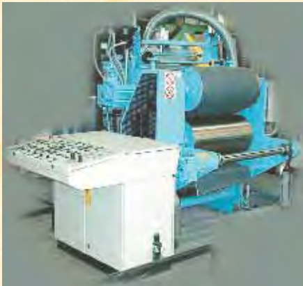
Laboratorio di goffratura e accoppiatura di film in PP espanso Embossing and laminating pilot unit of PP foam film
