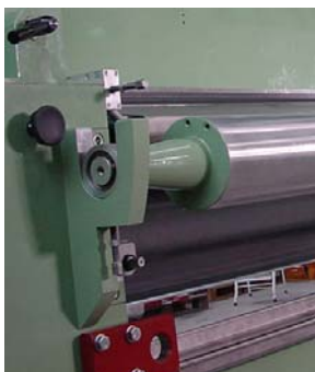
Cilindro di rinvio cromato anteriore Inlet chromed free cylinder
