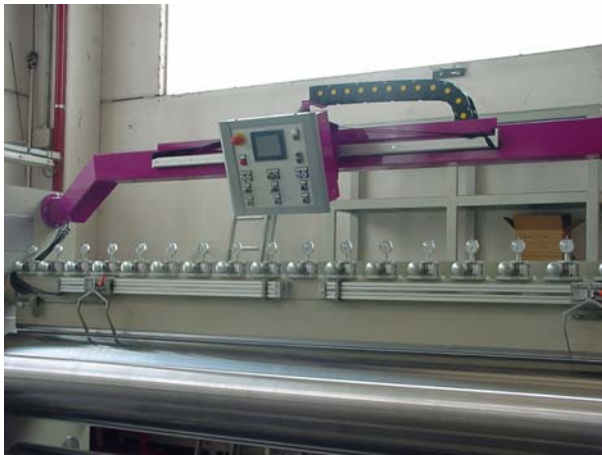
Dettaglio della plancia e regolazione trasversale della lama Particular of the control board and transversal regulation of the coating knife
