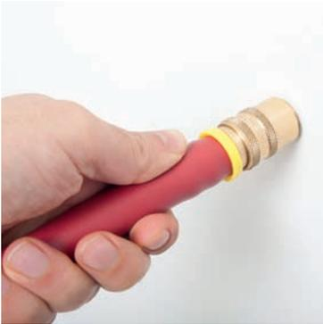
Nippel in den Schlauch stecken und bis zum gelben Anschlag eindrücken. Anschließend kurz zurück ziehen.
