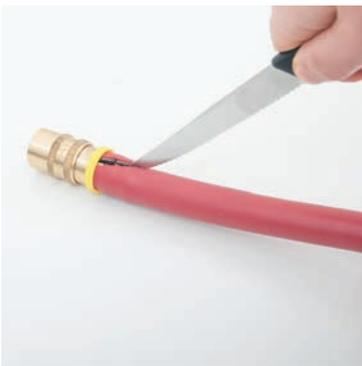
Mit einem Messer den Schlauch leicht schräg zur Längsachse aufschneiden. Dabei dürfen die Rippen des Nippels nicht beschädigt werden.
