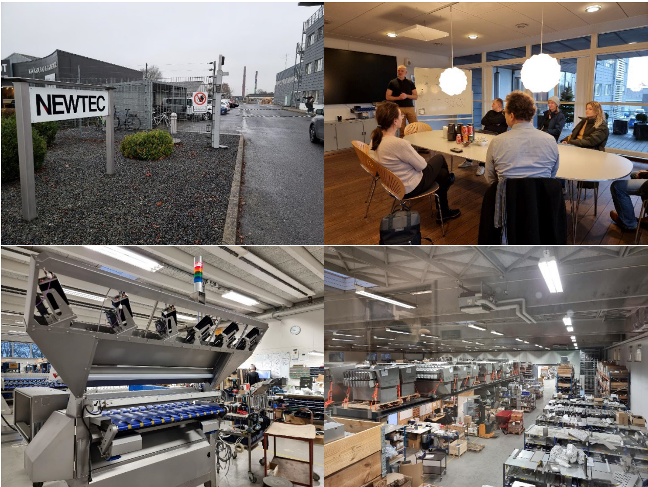
Bilder von links nach rechts: Eingang zu NEWTEC. PlastTrack im Besprechungsraum. Sortiermaschine mit 6 Hyperspektralkameras zur Inspektion. Montagehalle mit fertigen Sortiermaschinen für die Auslieferung.
