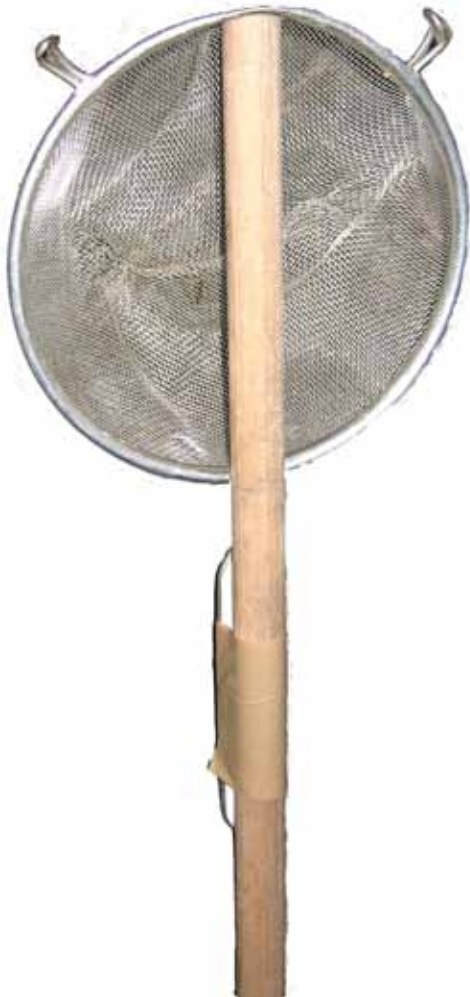
Figur 1 Stangsil. Det er viktig at skaftet er godt festet i kanten av sila, ellers vil den lett knekke.
