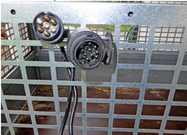
Kabel 2: Til biler med 13 polet stik
