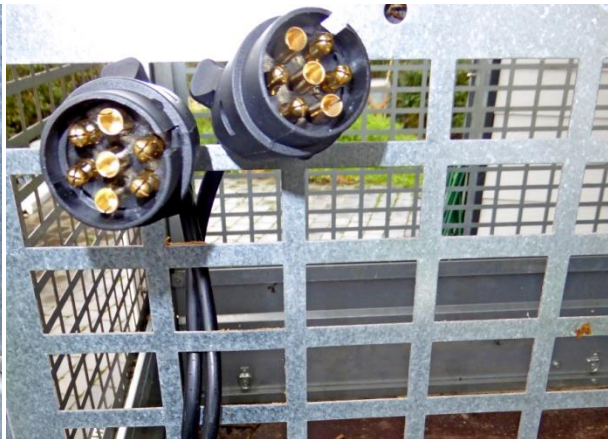
Kabel 1: til biler med 7 polet stik
