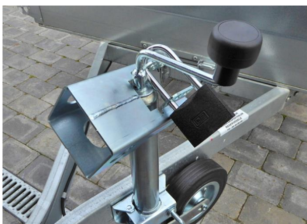
Låsen kan sættes fast på næsehjul under kørsel
