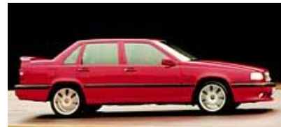
TWR har finjusterat både chassi och aerodynamik på 850R, vilket har resulterat i mer krängning och en ny bakvinge som ger ökat marktryck.
