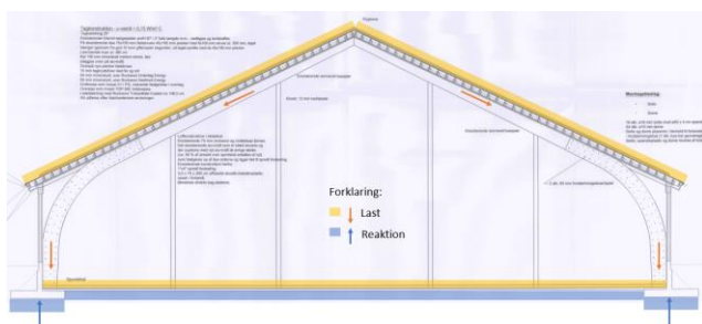
Figur 4.36: Bærende system for gymnastiksal
