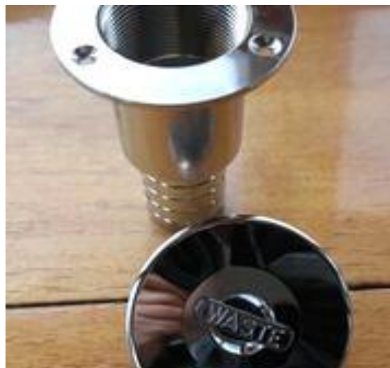
Det er denne du må ha montert for å imøtekomme standard ISO 8099
