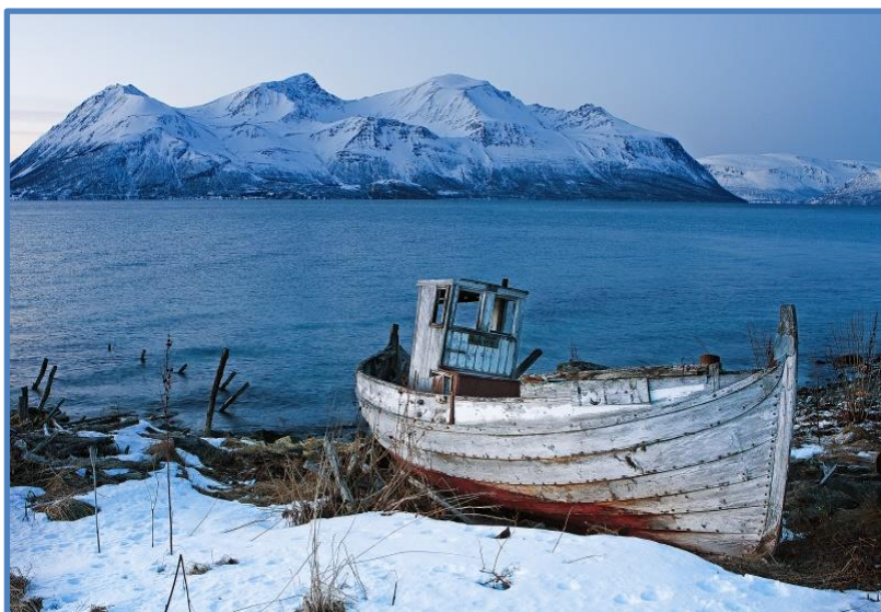
M/å «Kåre» er en typisk representant for en tidlig sjark – en motorisert nordlandsbåt med forhøyet rekke, et lite rorhus og lugar framme. Om bord står fremdeles en 4-5 Sabb semidiesel og et lite mekanisk garnspill.
