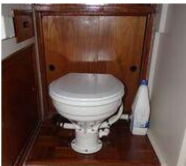
Her har det gamle Jabsco-toalettet fått motorisert seg med en TMC-tilsats som koster noen kroner mindre enn originalt Jabsco-tilsats.
