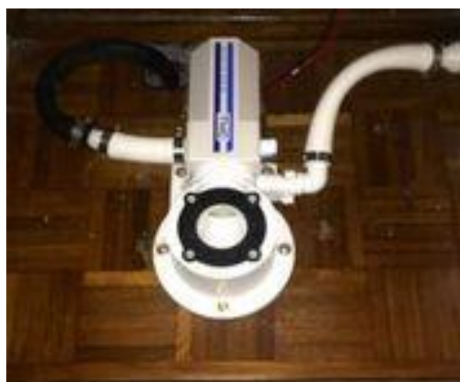
Her er den nye pumpedelen fra TMC på plass og vil passe perfekt på den gamle Jabsco toalettskålen.
