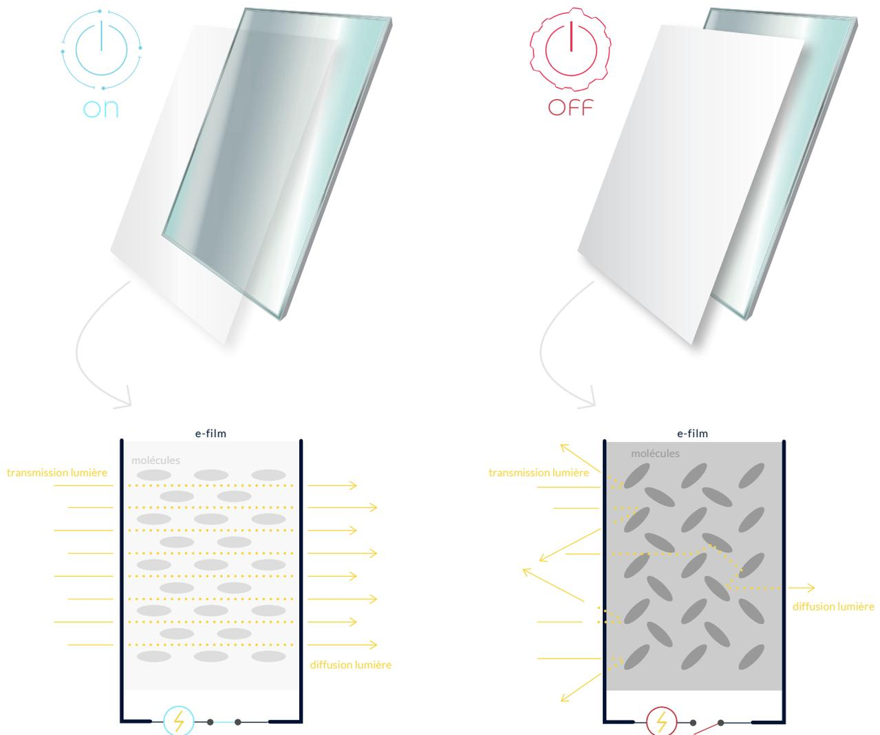
En mode ON, les molécules de cristaux liquides se positionnent de manière parallèle.
