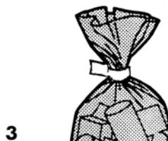
Figura 37: Selagem dos sacos com fita: 1) torce-se o saco, 2) a extremidade torcida é puxada através da máquina e a fita auto-aderente embrulha-se ao seu redor, 3) o saco fechado.
