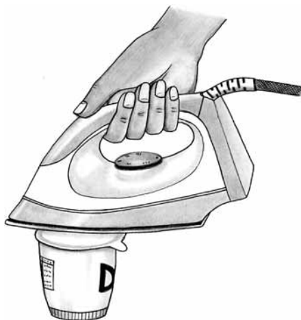
Figura 34: Selagem de tampas de folha com um ferro doméstico
