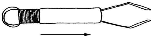
*Figura 5: Pequeno par de tenazes ou pinças curvas de metal. A secção do meio é amovível e pode inclinar-se para trás e para diante, de modo a abrir e fechar as pinças.*
