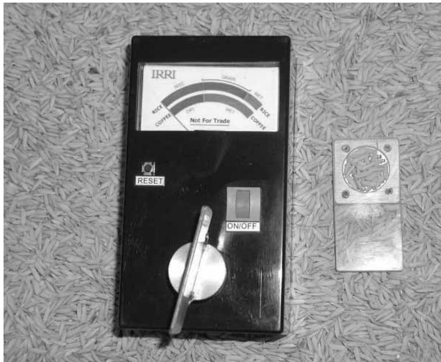
*Figura 25: Higrómetro electrónico para medir o teor da humidade das sementes. A seguir descrevemos como o higrómetro funciona.*
