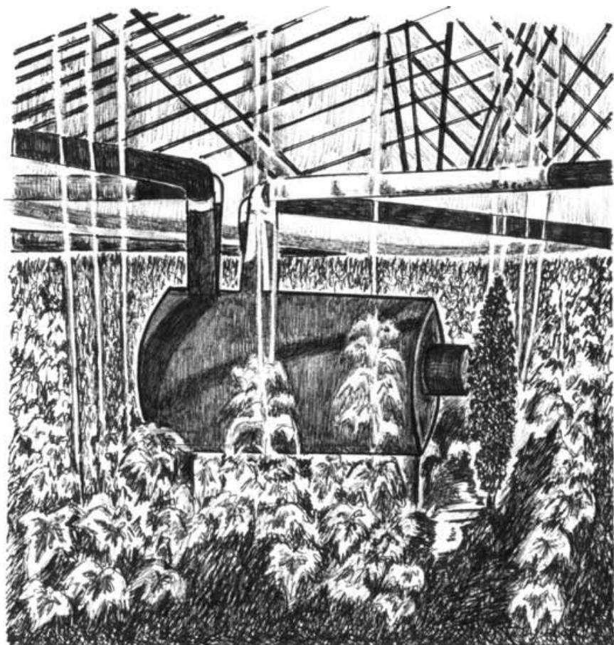
*Figura 18: Os tubos da fornalha aquecem toda a estufa*
