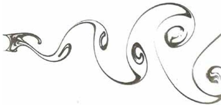
Klassische Karmanströmung im Wasser. Hier sind man besonders gut, wie das flüssige Element schwingt. Die zentripetale Einrollbewegung zeigt auch wie aus der Schwingung eine dreidimensionale Wirbelbewegung entsteht. Je nachdem ob Druck oder Zug der Auslöser für eine solche Schwingung ist, Mutationen hervorruft, sehen Kamianströmungen völlig unterschiedlich aus.
