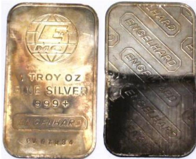
Damit die Silberbarren möglichst lange halten, sollte die Polarität jedes Mal umgekehrt werden. Dies bedeutet, dass der Silberbarren, der in einer Charge mit dem positiven (roten) Draht verbunden ist, so geschaltet werden sollte, dass er in der nächsten Charge mit dem negativen verbunden wird. Andernfalls wird einer der Balken schnell erodieren.
