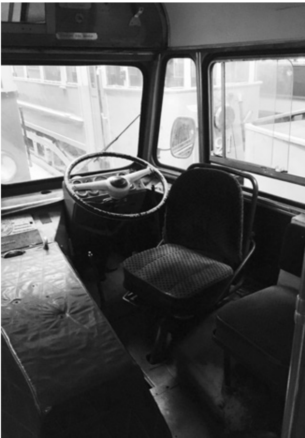
Inne i A 15163 ser vi at sjåføren satt på høyre side i en buss bygget på svensk chassis på 1950-tallet. Bak sjåføren var det et smalt sete til billettselgeren.
