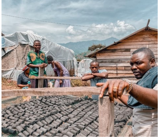
Le séchage des briquettes de charbon vert pendant la production
