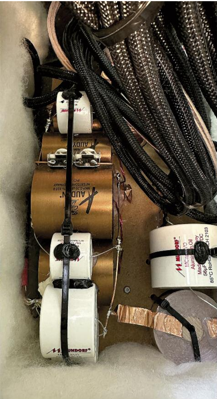
Erheblicher Aufwand: Mit dieser Weiche wird der 1-Zoll-Diamanthochtöner betrieben und an den Beryllium-Mittelhochtöner angekoppelt
