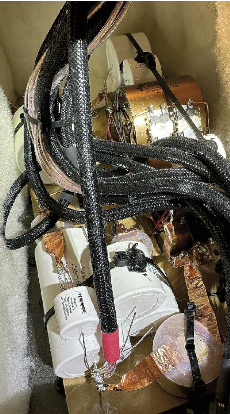
Das ist erst der Anfang: Ein Teil der hochwertig bestückten Weiche für den Basstreiber, daneben Dämpfungswolle aus einem Gemisch von synthetischer und echter Wolle, die darunter liegende schwere Dämpfungsmatten verdeckt
