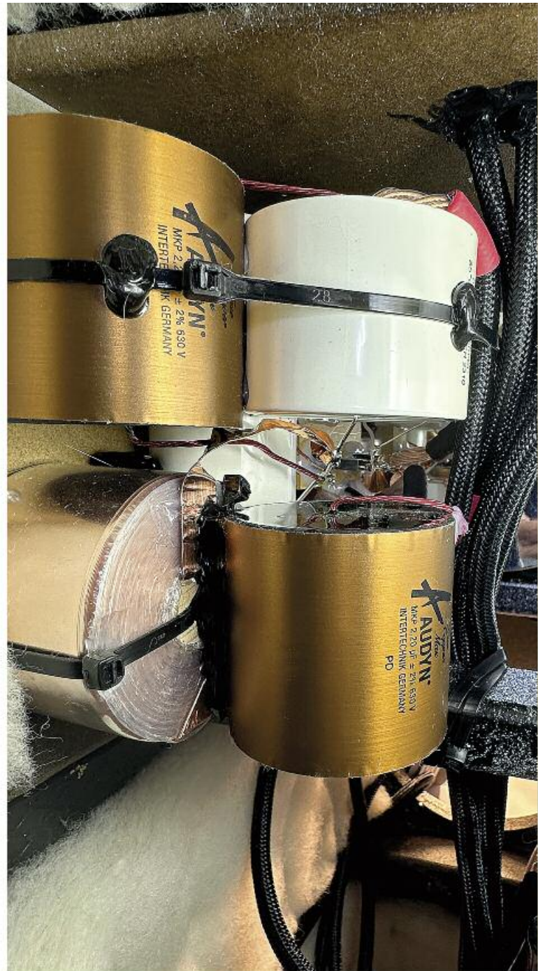
Die Weiche für den Mittelton-Basstreiber sitzt wie alle einzeln gruppierten Weichen auf einem eigenen Board. Unter dem Audyn-Kondensator liegt eine Kupfer-Flachbandspule von Mundorf
