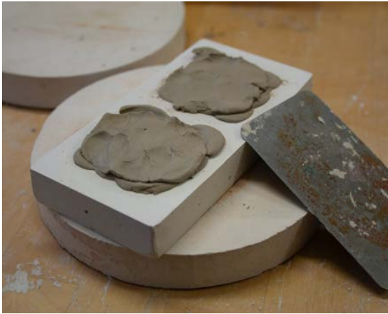
Figur 11: Prøvebiter av leire trykkformes i en tilskåret gipsmal.
