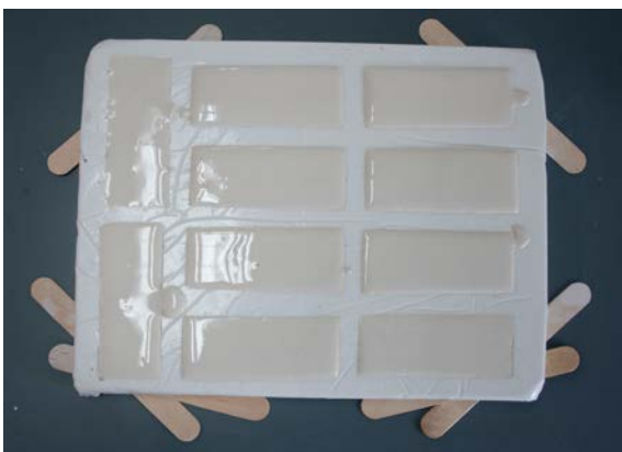
Figur 15: Prøvebiter av Molda 3 Normal støpt i silikonform.
