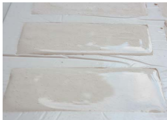
Figur 16: Nærbilde av gipsblandingens overskuddsvann som danner basseng på massens overflate.
