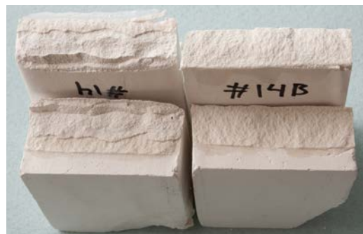
Figur 24: Syrefritt PVA på prøver av S2.
