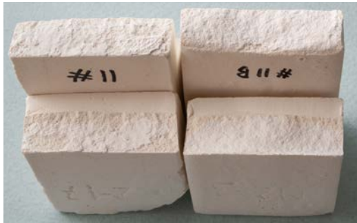
Figur 17: CalXnova Kalkinjeksjonsmørtel på prøver av M2.
