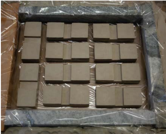
Figur 13: Produksjon av silikonform med 10 prøvebiter av leire.
