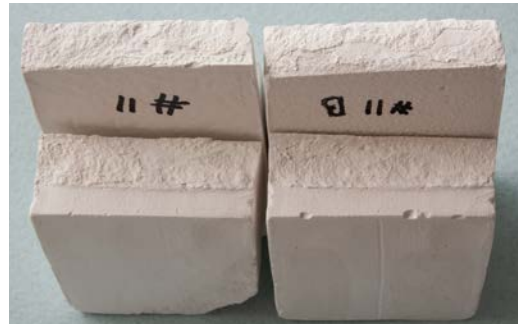
Figur 18: CalXnova Kalkinjeksjonsmørtel på prøver av S2.
