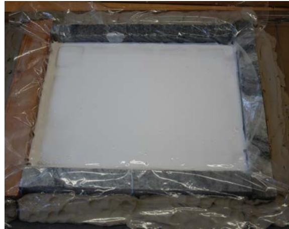
Figur 14: Silikonform støpt med Elastosil M4503 fra Wacker.
