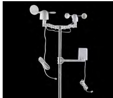
Fig. 3 Dispositivo Medidores de Precipitaciones y Viento (Dirección y Velocidad) 5
