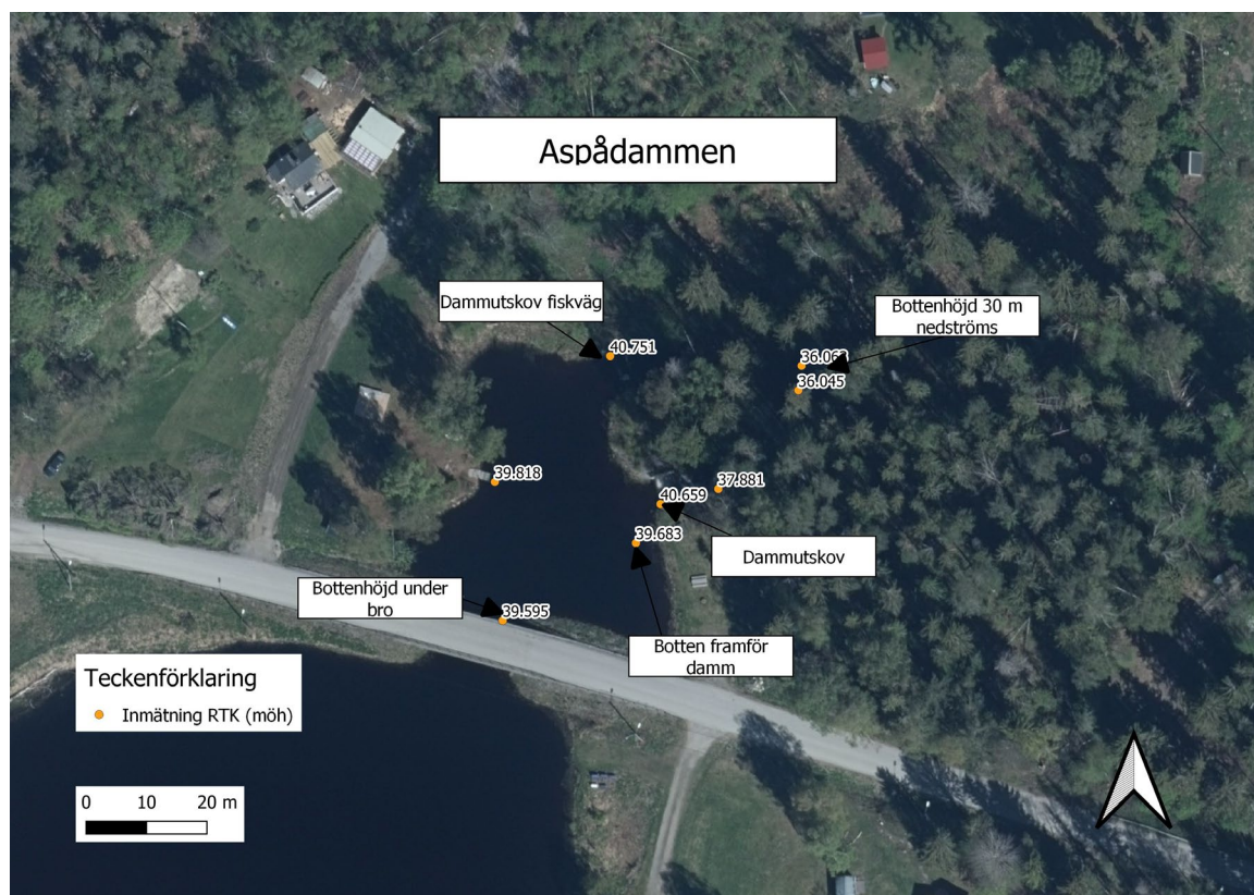
Figur 2. Resultat av inmätningar med RTK-GPS. Totalt faller det ca 4,6 meter från höjden på utskoven till botten ca 30 m nedströms.
