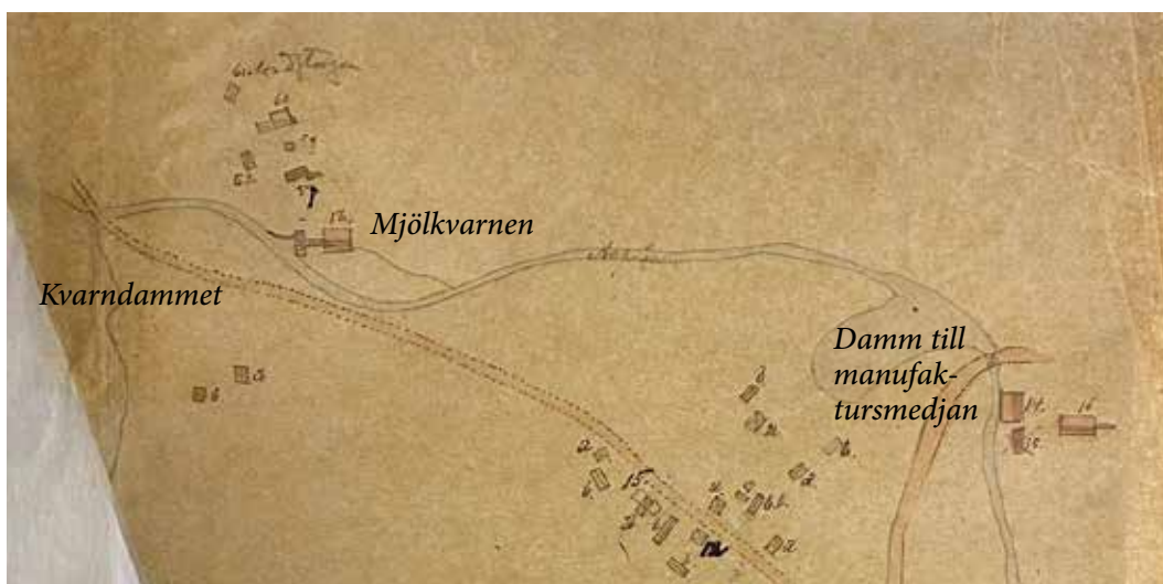
Karta till brandförsäkring 1889 (Volym 363, 28 901-28 950). Nr 13 är mjölkvarnen där vattnet leds i en separat fåra genom byggnaden och vidare ut i Aspån. Vattenfåran är än i dag synlig i landskapet. Nedströms syns manufaktursmedjans damm.
