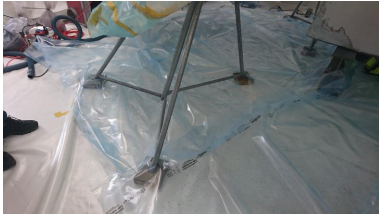
Figur 9. Marktäckning som utförts efter det att båten lagts upp på stöttor.
