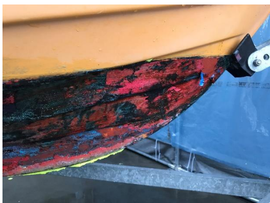
Figur 7. Fläktupställning för att generera vind (överst vänster), vattendammsugare för provtagning av övertransporterad bottenfärg och spolvatten (överst höger) samt fören på experimentbåten Ryds Utö efter avtvättning av en gelbehandling.
