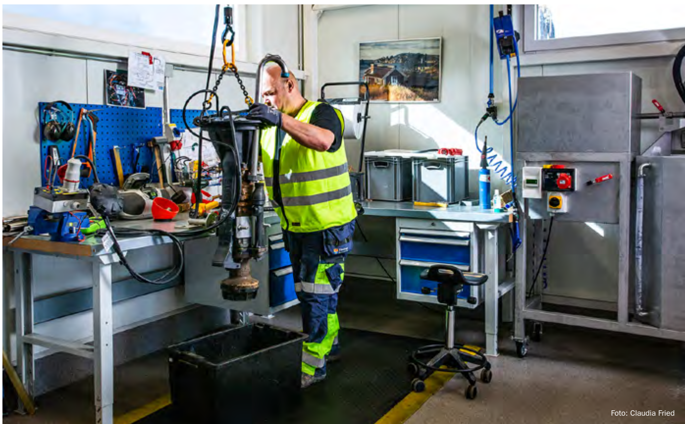
Bild 12. Arbete med LTA. Flera områden är utbyggda med lätt tryckavlopp (LTA) där varje fastighet har en egen pump för spillvatten.
