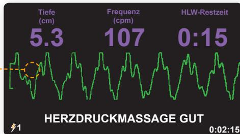
Der AED 3 BLS lässt sich leicht so konfigurieren, dass entweder nur das CPR Dashboard™ oder das CPR Dashboard zusammen mit dem EKG angezeigt wird. Tiefe und Frequenz werden rot markiert, wenn im Erwachsenenmodus die Kompressionsfrequenz zu langsam ist und/oder die Kompressionen zu flach sind.
