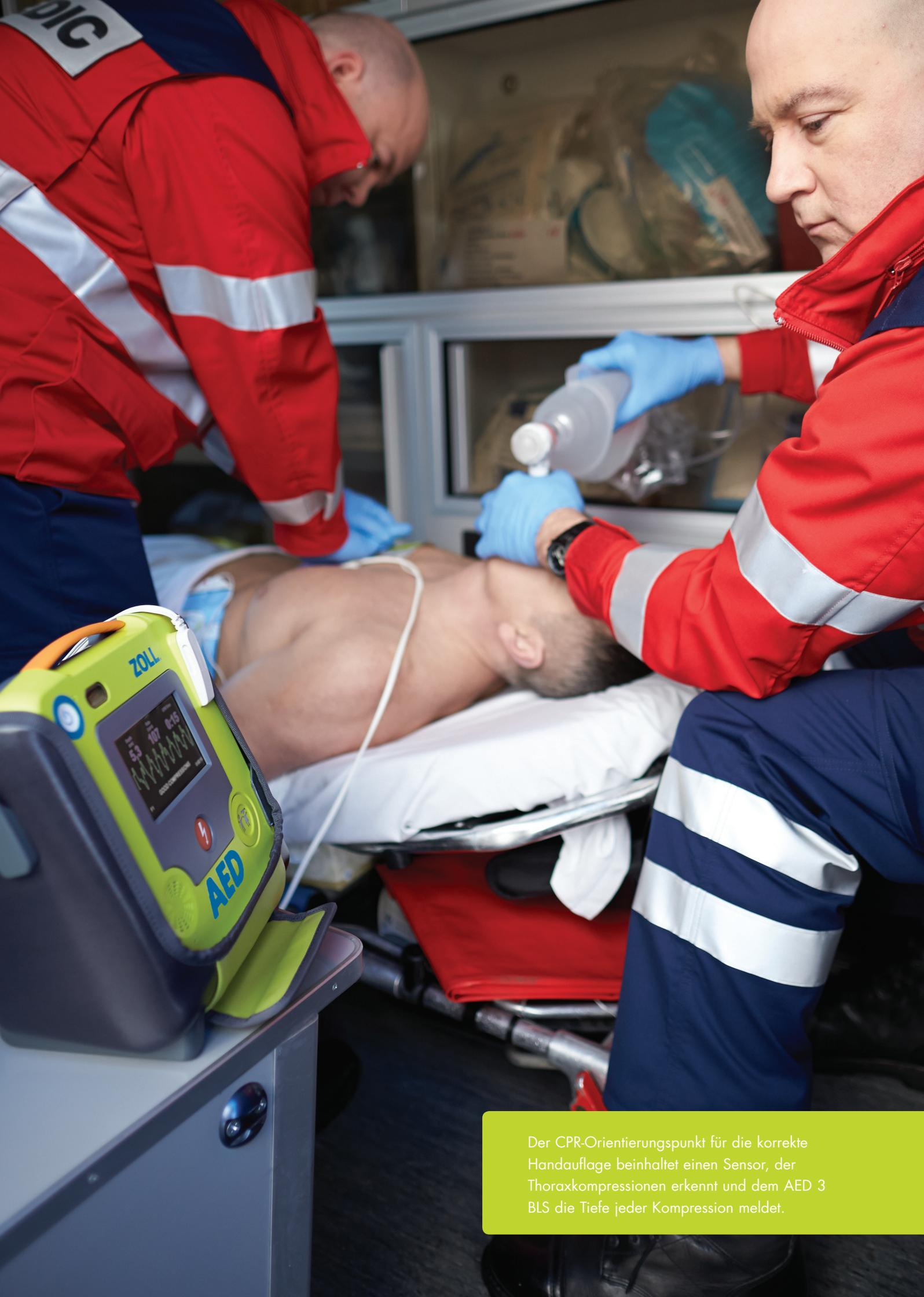
Der CPR-Orientierungspunkt für die korrekte Handauflage beinhaltet einen Sensor, der Thoraxkompressionen erkennt und dem AED 3 BLS die Tiefe jeder Kompression meldet.
