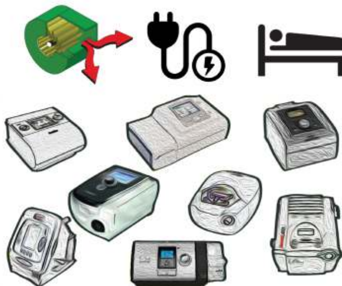
Fig. 7 | BiPAP-apparater. Turbindrevne apparater som brukes når pustestøtte er nødvendig bare deler av natten. Avhengig av strøm fra nettet.
