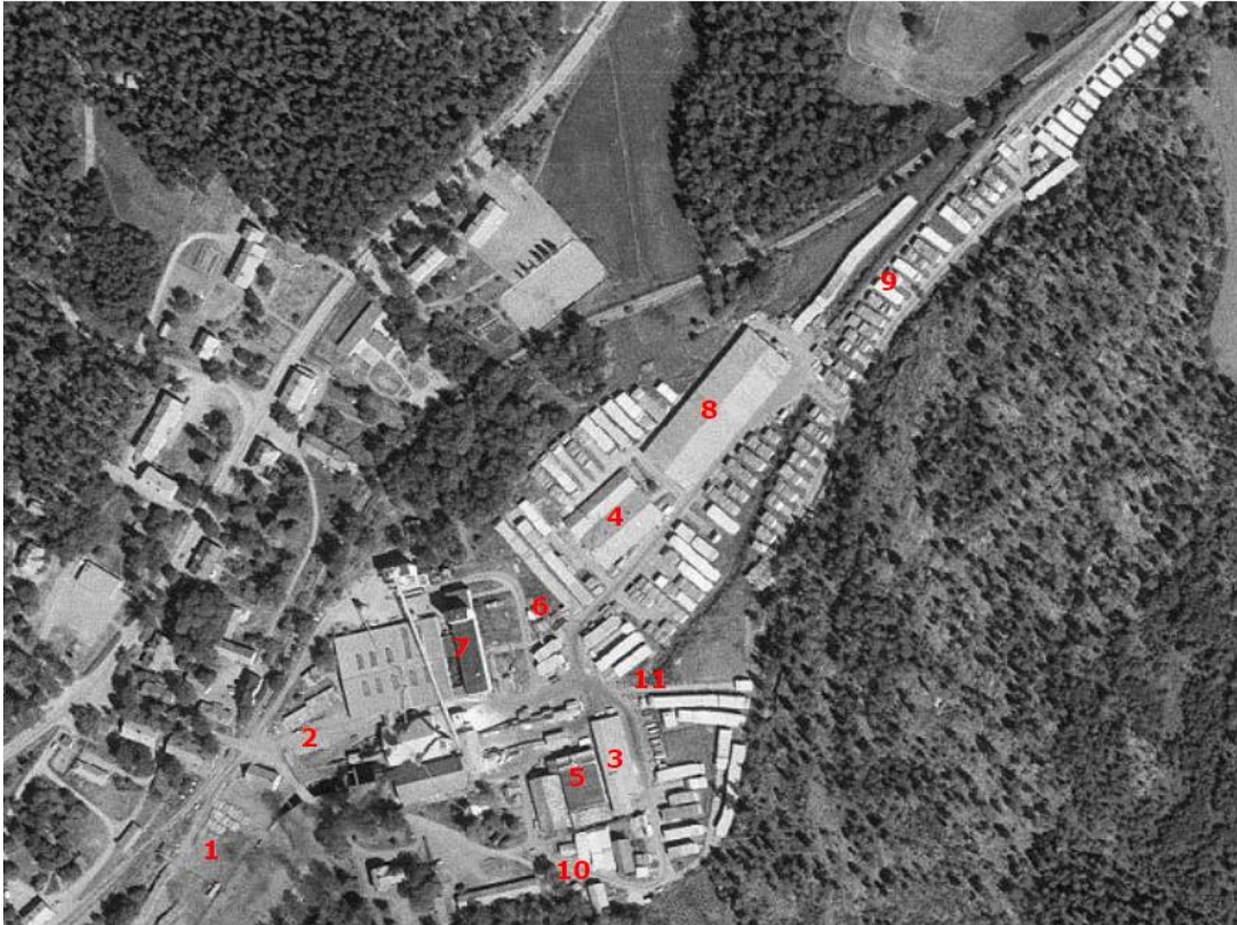
Figur 9. Flygbild från 1977 över Länholms bruk. Norr är uppåt. 1=timmsortering, 2=lagerplats (slaggrester och barkning), 3=kap, 4=gamla torkhus, 5=nya torkhuset, 6=dopningskar, 7=förvaring av tunnor med PCP-salt, 8=virkeslada, 9=virkesupplag, 10=dieseltank med handpump, 11=ytvattenupdrag, markeringen avser slutet av kulvertering. Bild från tidigare huvudstudie (Ramböll, 2014a).
