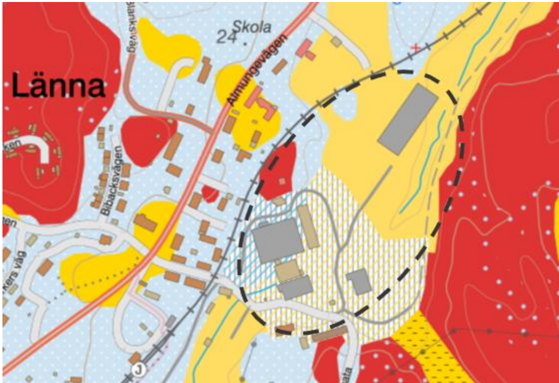
Figur 1. Jordartskarta hämtad från SGU:s karttjänst (2023) med fyllnadsmassor (streckat), berg i dagen (rött), lera (gult) och morän (ljusblått). Utbredningen på det aktuella området är schematiskt markerat med svart streckad linje.
