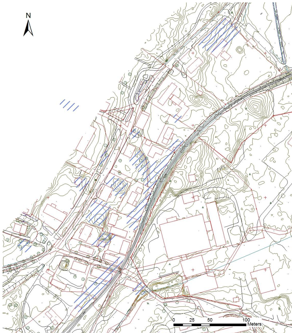
Figur 7. Skrafferade ytor visar uppskattad utbredning av förorening och fyllnadsmaterial med tydliga rester från bruksverksamheten
