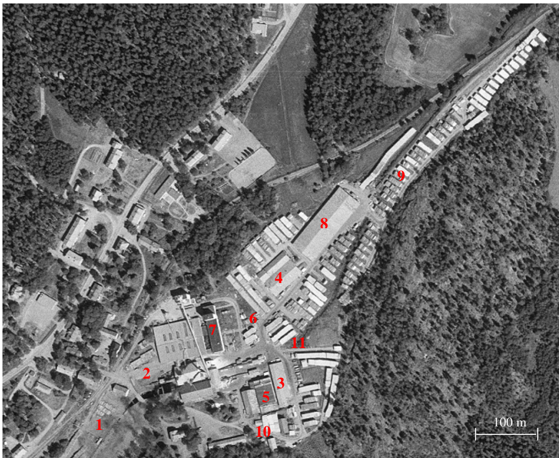
Figur 1. Flygbild från 1971 över Lännaholms Bruk. 1=timmersortering, 2=lagerplats (slaggrester och barkning), 3=kap, 4=gamla torkhuset, 5=nya torkhuset, 6=doppningskar, 7=förvaring av tunnor med PCP-salt, 8=virkeslada, 9=virkesupplag (stabbar, finns över stora ytor inom bruksområdet), 10=dieseltank med handpump, 11=ytvattendrag, markeringen avser slutet av kulvertering. Norr uppåt.
