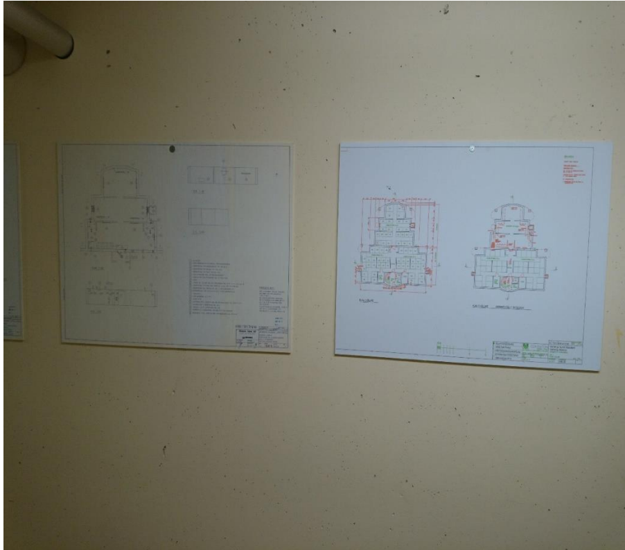
Bild 3. Arbetsritning (svart text; till vänster) och relationsritning/iordningställanderitning (röd/grön text; höger)
