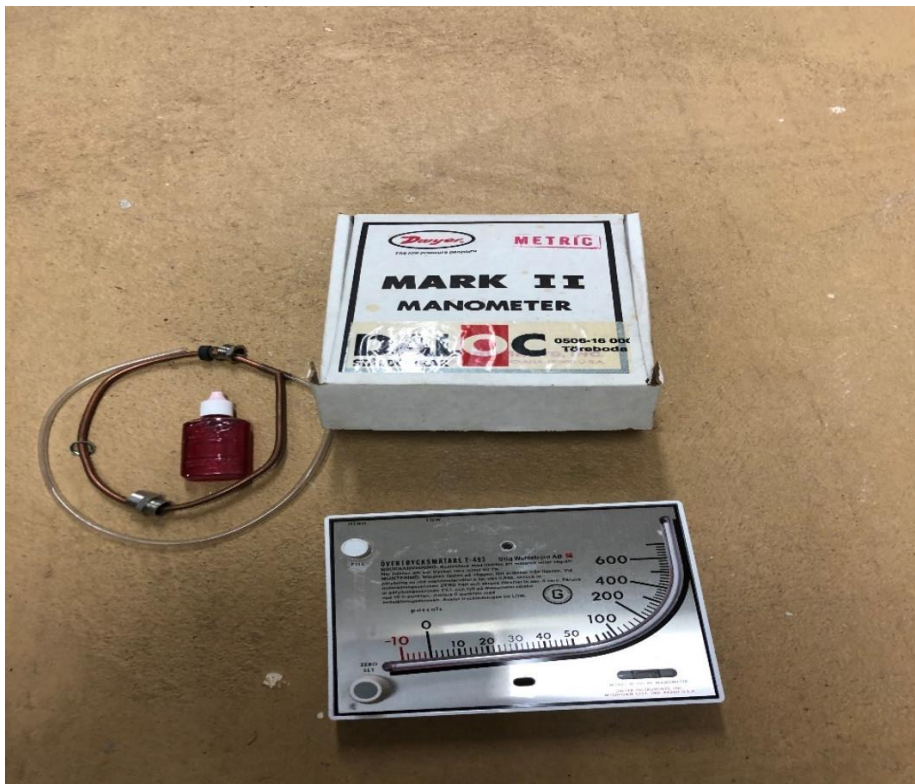
Bild 26. Övertrycksmätare (väggmonteras nära västra reservutgången)
