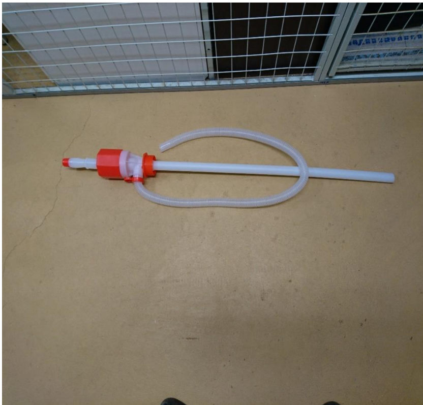
Bild 30. Hävertpump (pumpning från vattentunna till vattendunk)
