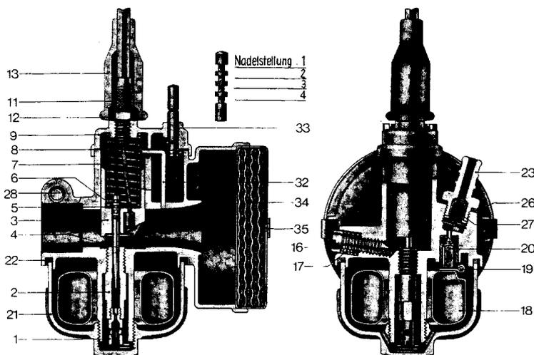
befestigt werden, welche wie der Kegel der Düsenadel die angesaugte Kraftstoffmenge beeinflussen. Eine höhere Nadelstellung ergibt einen größeren Ringquerschnitt in der Nadeldüse, der mehr Kraftstoff durchläßt und umgekehrt. „Nadelstellung 2“ bedeutet dabei, daß die Düsenadel mit dem zweiten Einstich von oben in das federnde Halteplättchen (5) eingehängt ist.
