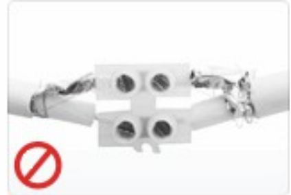
Kabler med forkerte eller dårlige samlinger
