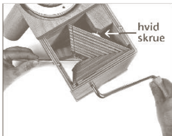
4., 5. Afmonter håndtaget, Løsn skruen
