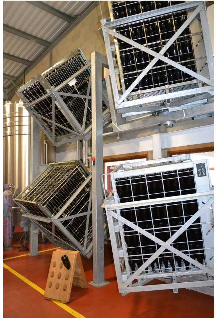
Gyropaletter på Ridgeview som gör remuage dvs får jästfällningen att hamna i flaskans hals efter andra jäsningen på flaska inför degorgeringen (avlägsnande av jästfällningen).
