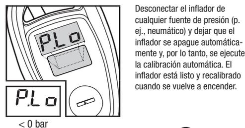
Desconectar el inflador de cualquier fuente de presión (p. ej., neumático) y dejar que el inflador se apague automáticamente y, por lo tanto, se ejecute la calibración automática. El inflador está listo y recalibrado cuando se vuelve a encender.
