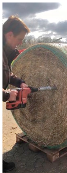
Probenahme mit dem neu entwickelten Probenzieher, Fa. Gebhardt Anlagentechnik GmbH & Co. KG
