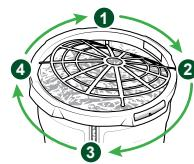
**8** Um den Regulator einzusetzen, greifen Sie den mittleren Teil des Regulators mit beiden Händen und biegen Sie ihn, indem sie die Arme der Clips vorsichtig durch den Spalt in den Seitenwänden führen.
