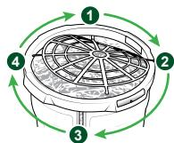
**8** Pour insérer le régulateur, placez les deux mains dans la partie médiane du régulateur et pliez soigneusement les bras des clips à travers l'espace dans les panneaux latéraux.
