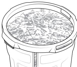
**7** Füllen Sie das Gerät mit Heu oder Heulage, um sicherzustellen, dass das Futter sehr gut aufgelockert und nicht zu kompakt im Gerät ist.
