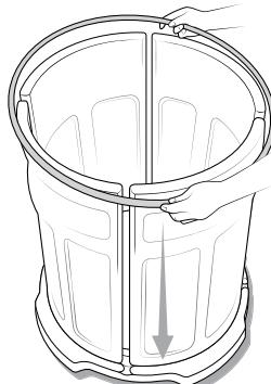
**1** Entfernen Sie den Aufsatz vom Sockel und füllen Sie 20 kg ofengetrocknetem Sand ein (optional). Drücken Sie den Aufsatz fest in den Sockel zurück, sodass er sicher befestigt ist. Sie sollten ein Klicken hören.
