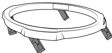
**4** Wenn er dort ankommt, befinden sich die 4 Gummikeile auf der Innenseite des Ringaufsatzes. Ziehen Sie alle Keile nach unten, wie durch den Pfeil rechts neben jedem Keil angegeben, so dass sie nach unten hängen. Achten Sie darauf, dass Sie sich nicht vollständig lösen. Dadurch entsteht Platz im Ringaufsatz, um den nächsten Schritt zu ermöglichen.
