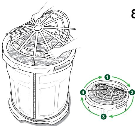
**8** Per inserire il regolatore, posizionare entrambe le mani nella parte centrale del regolatore e piegare, facendo passare con attenzione i bracci delle clip attraverso lo spazio nelle pareti laterali.
