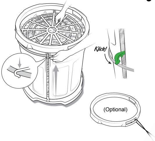
**9** Drücken Sie jeden Clip fest auf den Metallring, bis Sie hören und sehen, dass er sicher auf dem Metallring einrastet.
