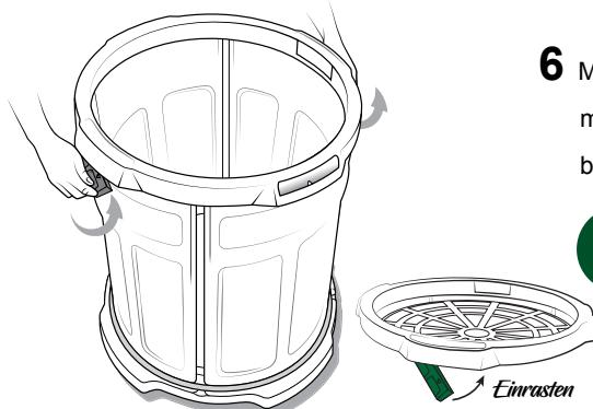
Fühlen Sie nach einem ‚Klick‘, um sicherzustellen, dass der Keil fest im Ringaufsatz sitzt.
