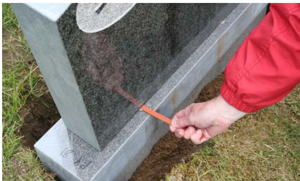
Figur 6. Kontroll av antalet dubbar med bågfilmsblad.
