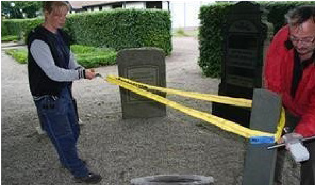
Figur 7. Belastningstest med fjädervåg, lyftstroppslinga och fender, här i form av bildäck.
