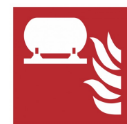
Стационарна пожарогасителна инсталация
