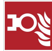
Линия сухого пожаротушения
