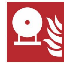
Фиксированная огнетушащая бутылка
