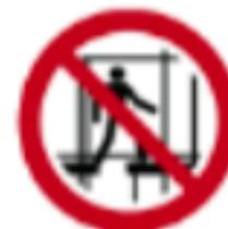
Запрещено использование неполной комплектации строительных лесов
