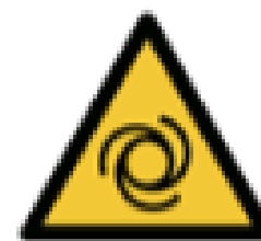
Pornire (automata) de echipament
