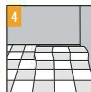
4 Der Kleberauftrag für die nächste Bahn muss lückenlos an den ersten Kleberauftrag anschließen. An den Kopfenden den Belag etwas gegenbiegen und dann ins Kleberbett legen.
