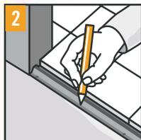
**2** Grundschiene in die Aussparung im Boden einsetzen (Randabstand beachten!). Dübellöcher markieren und bohren. Dann die Dübel einsetzen und die Schiene festschrauben.
