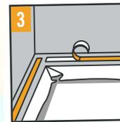
**3** Den Teppichboden nach einer Akklimatisierung von etwa 12 Stunden zuerst grob beschneiden. Am Wandverlauf muss der Teppichboden fixiert werden. Hierzu ein doppelseitiges Teppichklebeband oder Pilzkopfklebeband auf dem Boden ankleben, aber noch nicht das obere Schutzpapier abziehen. Jetzt kann der Teppichboden in die Kanten zur Wand hin eingedrückt und beschnitten werden – trage auch dabei zur Sicherheit Arbeitshandschuhe.
