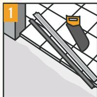
**1** Dort, wo unterschiedliche Bodenbeläge aufeinandertreffen, entstehen leicht Stolperkanten, z. B. im Türbereich. Mit sogenannten Übergangsschienen kann man solche Kanten abdecken. Schneide entsprechend des Türmaßes die Übergangsschiene zu. Die Dicke der noch fehlenden Türzarge dabei rechts und links von der Schienenlänge abziehen.
