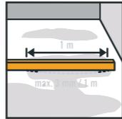
Der Untergrund muss trocken und eben sein. Beachte hierzu auch die Herstellerempfehlungen. Unebenheiten größer als 3 mm pro Meter müssen ausgeglichen werden, z. B. mit einer Fließspachtelmasse.
