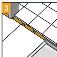
**3** Mit Holzstreifen eine 10-mm-Dehnfuge sichern und den Boden entlang dieser Fuge weiterverlegen. Zum Schluss einfach die Abdeckung in die Übergangsschiene eindrücken.
