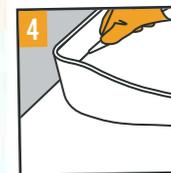
**4** Jetzt den Teppichboden wieder zurück-schlagen und das obere Schutzpapier vom doppelseitigen Klebeband abziehen. Danach den Teppichboden fest auf dem Klebeband oder Pilzkopfband andrücken.
