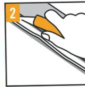
**2** Der Teppichboden wird auf dem Boden ausgerollt. Sind zwei Bahnen nötig, werden die beiden Verbindungskanten beschnitten. Hierzu den Teppichboden an der Verbindungsnaht überlappen lassen und entlang einer Stahl-schiene beide Teile gleichzeitig mit einer scharfen Klinge durchtrennen – trage ab hier zur Sicherheit Arbeitshandschuhe. Die beiden Bahnen nun mit einem einseitigen Klebeband auf der Rückseite zu einer Fläche verbinden.
