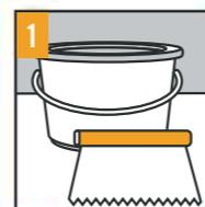
1 Beim vollflächigen Verkleben sind die Verarbeitungshinweise des Klebstoffherstellers zu beachten. Verwende am besten lösemittelfreie Dispersionskleber und einen Zahnschachtel mit der dafür vorgeschriebenen Zahnung.
