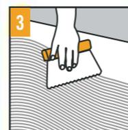
3 Die Bahnen werden nun zur Raummitte hin zurückgeschlagen und der Klebstoff vollflächig auf den Boden aufgetragen. Nach der vorgeschriebenen Abluftzeit kann die erste Bahn ins Kleberbett eingeschoben werden.
