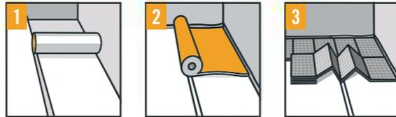
1 Verlege je nach Untergrund eine Dampfbremsfolie. Die Folienbahnen mit einer Überlappung von 10 cm verlegen und die Enden mit Alu-Dichtband dampfdicht verkleben. An den Rändern die Folie ca. 5 cm nach oben klappen. 2 & 3 Verlege anschließend zum Schutz des Bodens und zur Verbesserung des Wohnkomforts eine Verlegeunterlage, welche genau zu Deinem ausgewählten Bodenbelag und zum Untergrund passt. Diese ist als Rollenware oder in Form von Faltplatten erhältlich.
