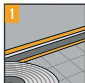
1 Falls Du eine Unterlage mit integrierter Dampfbremsfolie verlegst, solltest Du die umlaufenden Ränder mit Dicht- und Distanzband abdichten.
