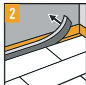
2 Der enthaltene Distanzschaum wird nach dem Verlegen des Bodens entfernt. Das Dicht- und Distanzband wird an zwei Raumseiten verlegt, das einfache Dichtband umläuft den Rest des Raumes.
