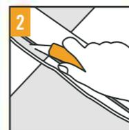
2 Werden wegen der Raumgröße mehrere Bahnen benötigt, führe an den Nahtstellen einen Nahtschnitt durch. So passen die Bahnen anschließend lückenlos zusammen.
