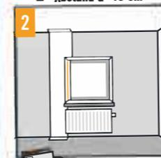
**2** Das Feld für die erste Tapetenbahn einkleistern. Die zugeschnittene Tapetenbahn an der Wand mit 3 cm Überstand zur Decke ansetzen, nach unten abrollen, dabei an der Linie ausrichten und mit der Tapezierbürste feststreichen. **3** Schneide die Tapete oben an der Fensterlaibung mit der Schere waage-
