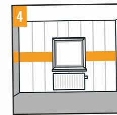
**4** Über dem Fenster beginnst Du an der Fenstermitte und tapezierst nach links und nach rechts. In der Verlängerung der Laibungskante erfolgt ein Doppelnahtschnitt. Dabei trennst Du die beiden überlappenden Tapetenbahnen gemeinsam durch und entfernst die Überstände. Unterhalb und oberhalb der Fensterbank schneidest Du die Tapete waagrecht ein. Direkt hinter einem Heizkörper wird nicht tapeziert. Im weiteren Verlauf die angrenzenden Wände auf Stoß tapezieren.
