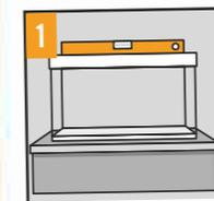
1 Prüfe zuerst mit einer Wasserwaage, ob das Aquarium eben auf dem Unterschrank steht. Lege eine Schutzmatte unter das Aquarium, weil schon kleinste Steinchen oder andere Partikel unterm Glas das gefüllte Aquarium beschädigen können.
