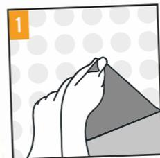
**1** Alte Tapeten müssen restlos von der Wand entfernt werden. Am besten weichst Du sie mit warmem Wasser ein, dann lässt sie sich leichter mit einem Spachtel abtragen. Für das Einweichen kannst Du eine Tiefengrundbürste verwenden. Das Wasser dringt besser in die Tapetenschichten ein, wenn Du sie vorher mit einer Igelwalze perforierst. Verbessert wird die Wirkung des Einweichens noch mit einem Tapetenlöser.
