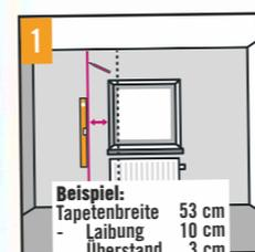
**1** An den Wänden wird mit dem Lichteinfall tapeziert, also immer vom Fenster zu den Zimmerecken. Als erstes die Fensterlaibung plus 3 cm Überstand messen. Den Wert von der Rollenbreite abziehen und den verbleibenden Abstand am Fenster z. B. nach links anzeichnen. Mit Wasserwaage oder Senklot eine Linie für die erste Tapetenbahn markieren. Den Kleber anrühren und ziehen lassen.
