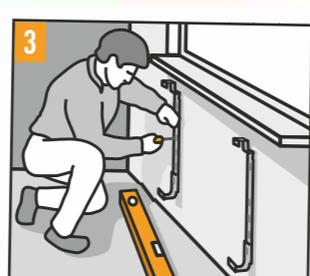
des Heizkörpers. **3** Bestimme die Höhe der Befestigungslöcher für die Wandbefestigung so, dass der Heizkörper zum Boden mind. 15 cm und nach oben zu einer Fensterbank mind. 10 cm Luft hat.
