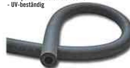
Verwendbar für Solaranlagen, um den Wärmeverlust zu reduzieren. Das Material bietet eine hohe Temperaturbeständigkeit und ist deshalb auch für die Zuleitungen geeignet, an denen Temperaturen von 150 °C nicht unüblich sind. Das Material ist UV-beständig und kann deshalb auch im Außenbereich verwendet werden.
