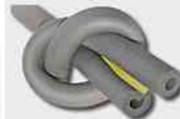
Verwendbar für den Heizungs- und Sanitärbereich, um bei Warmwasserrohren den Wärmeverlust zu reduzieren und Kaltwasserrohre vor Schwitzwasser zu schützen. Die selbstklebende Folie erleichtert das Verschließen der Isolierung am Rohr. Im Bereich der Bögen sind keine Gehrungsschnitte erforderlich, da das Material hochflexibel ist.
